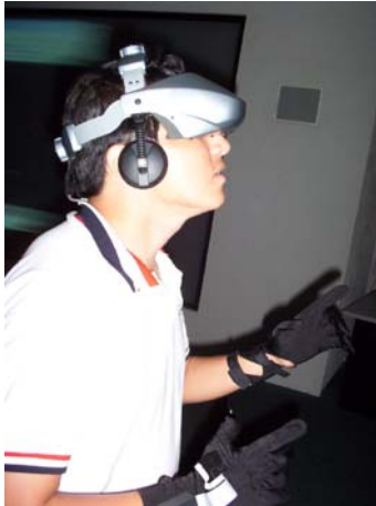
Figura 2. Sistema de realidad virtual de inmersión completa. Fotografía del autor.
